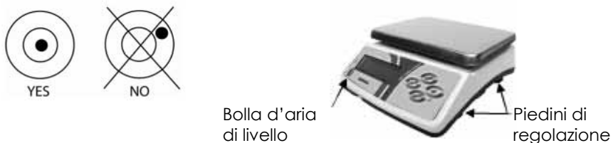
Figura 2-1. Messa a livello della bilancia.
